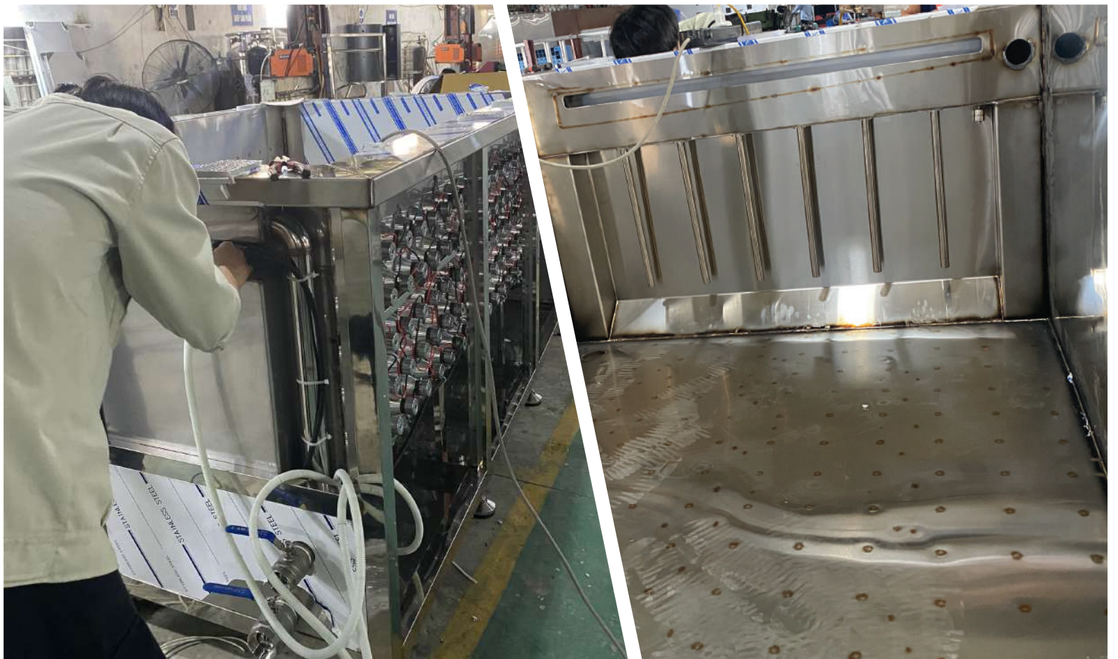
Lắp ráp và hoàn thiện bể rửa sóng siêu âm 1000l OEM theo thương hiệu đối tác
