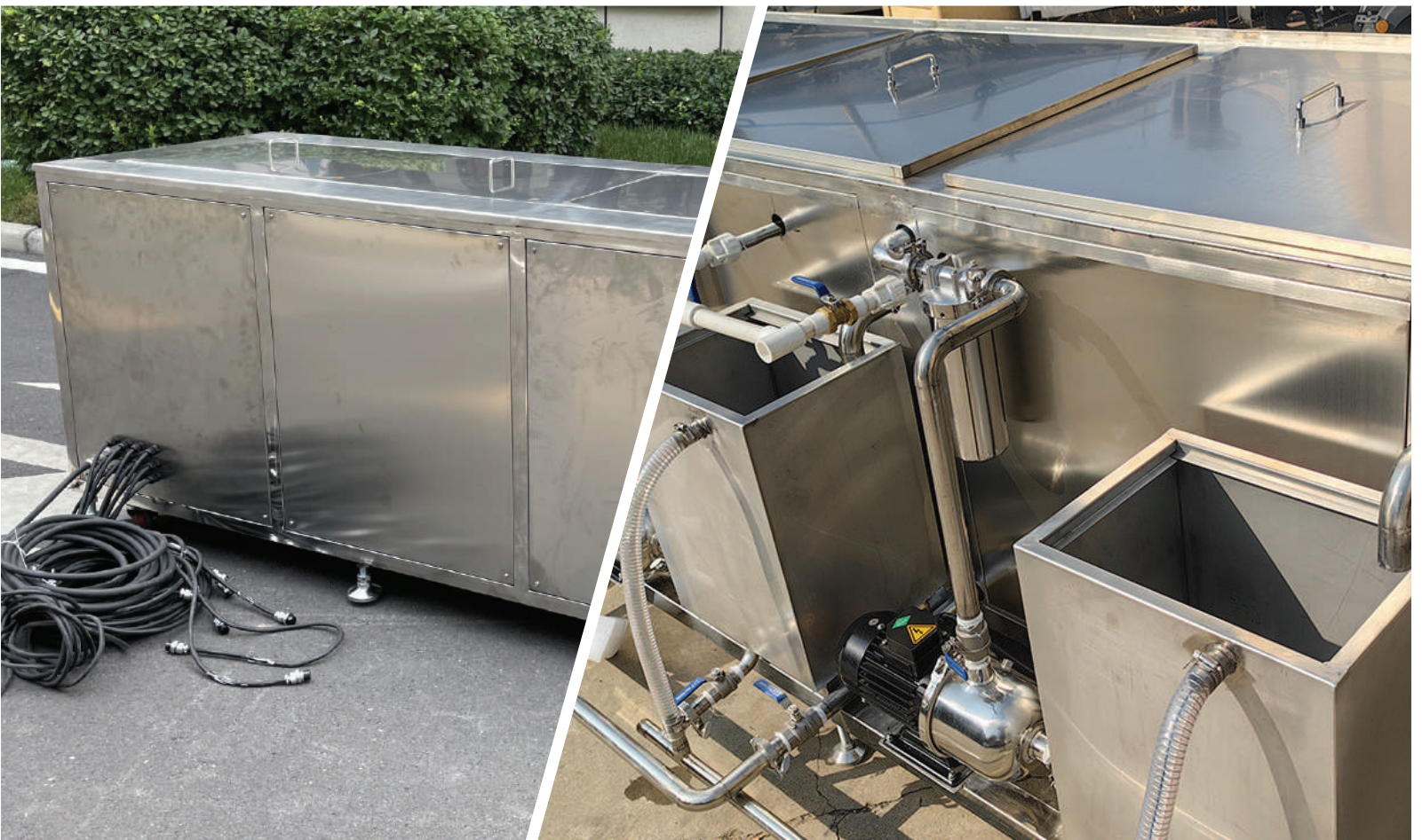
Bể làm sạch siêu âm ba bồn 96l Model UTS-T96L cho nhà máy sản xuất mạch tại cụm CN Thạch Thất, HN
