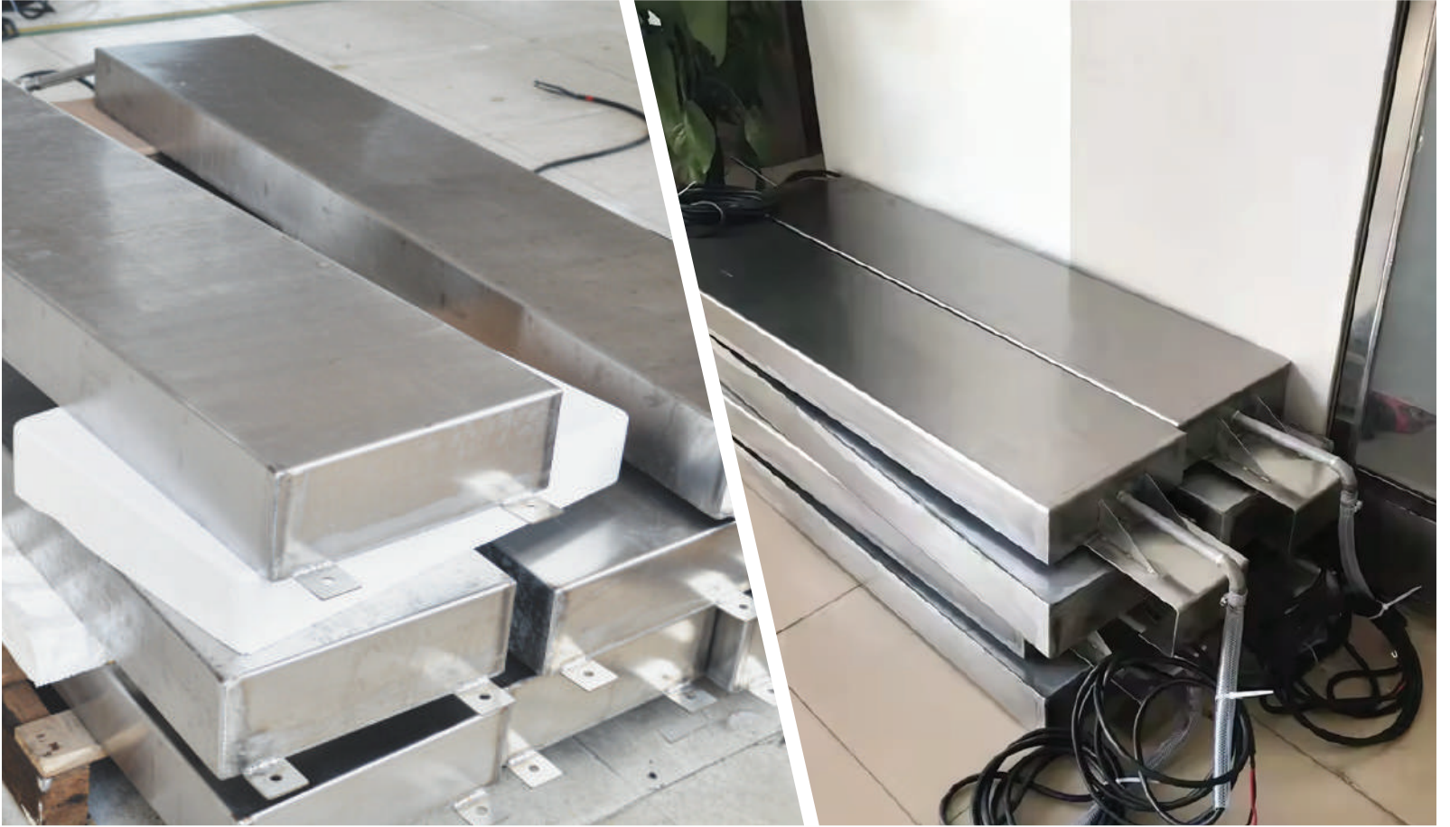
Dự án cải tạo bể làm sạch bằng tấm rung sóng siêu âm 1000W cho dây chuyền xi mạ tại Bình Dương
